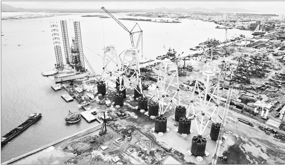
Sản xuất chân đế điện gió ngoài khơi tại cảng PTSC (tỉnh Bà Rịa-Vũng Tàu).
